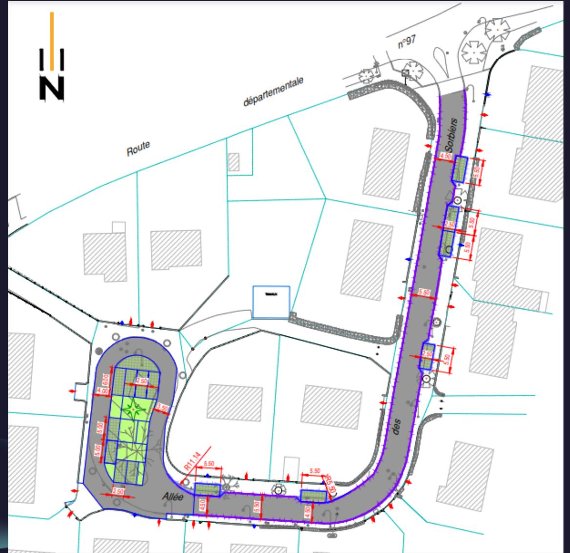
Les travaux consistent en un rechargement de la voie, avec une reprise des bordures au droit des entrées de garages. La vue des bordures sera variable de 2 à 4 cm suivant les endroits.
